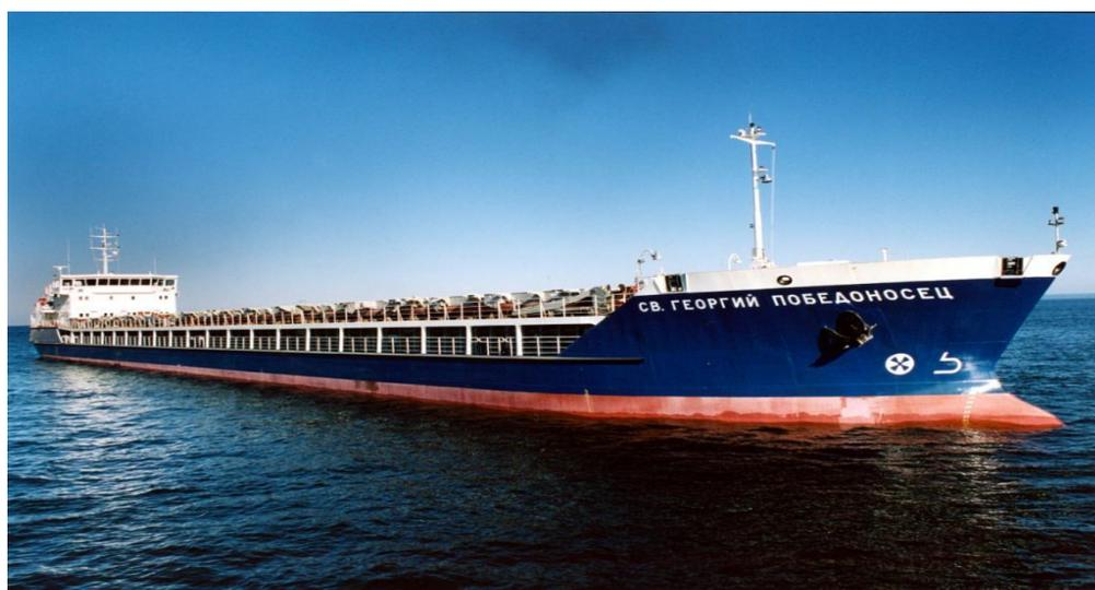
Рис. 3. Двухвинтовое судно смешанного плавания проекта ОАО «Вымпел» 01010
