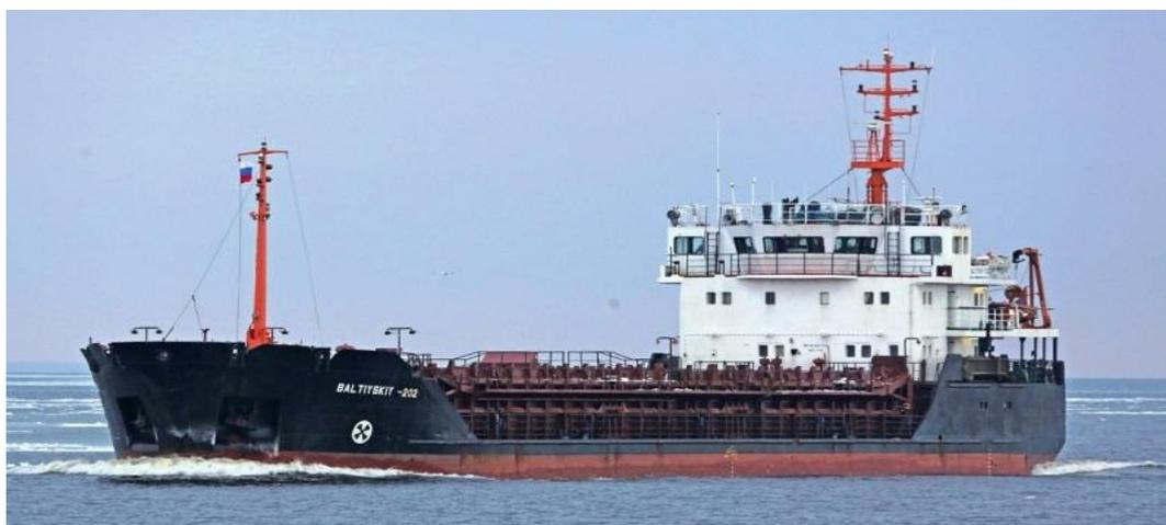
Рис.2. Одновинтовое судно смешанного плавания «европейского» проекта 16290
