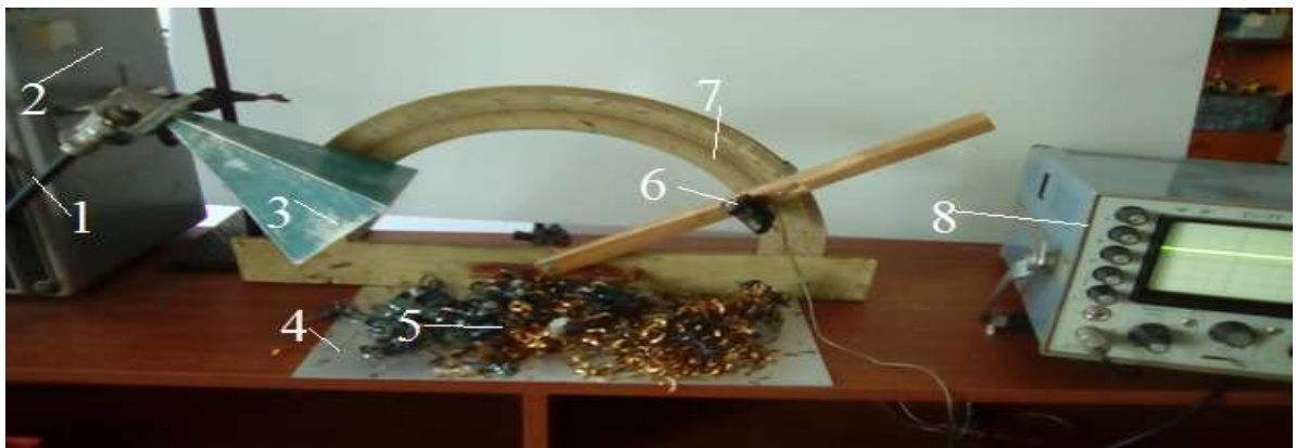
Рис.6. Установка для опыта по исследованию отражения электромагнитных волн от поверхности из дискретных металлических элементов.
