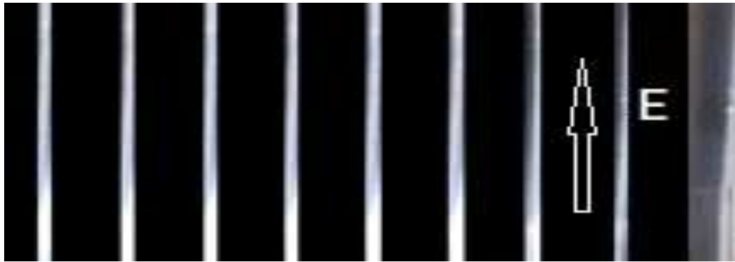
Рис.2.Металлопластинчатая структура с n < 1 .
