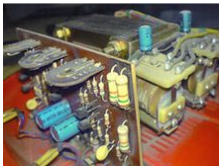
Стабилизатор напряжения с использованием электромеханических реле для переключения.
