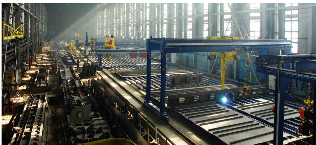
Рис. 5. Корпусно-сборочный цех ОАО «Невский ССЗ». Линия IMG
