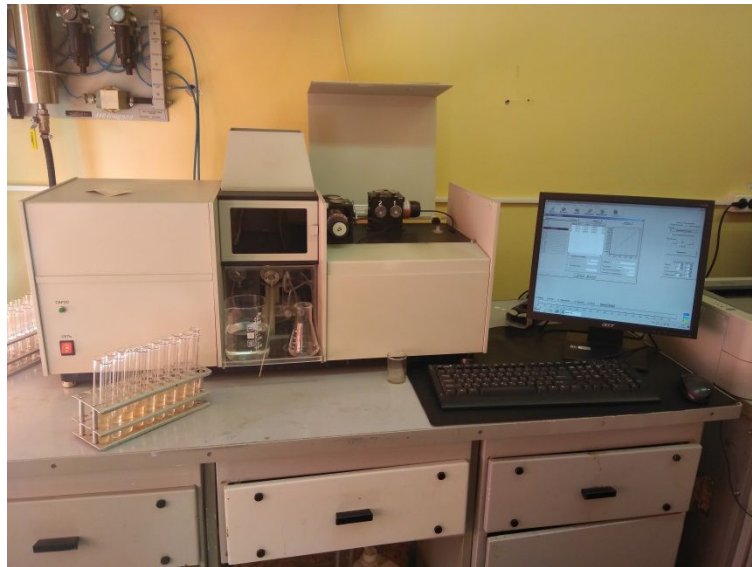
Рисунок 1 - Исследование атомно-абсорбционным методом образцов сыра на содержание тяжелых металлов и микроэлементов
