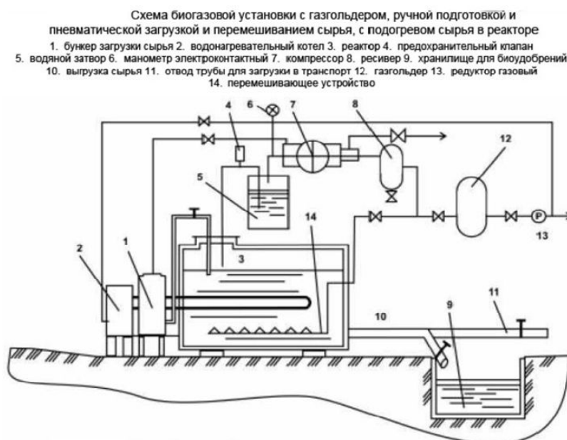
Рисунок1 «Схема биогазовой установки»[2:188]
