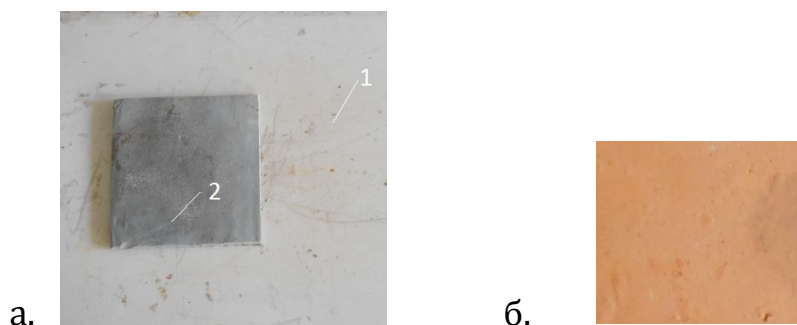
Рис.1.Заготовка керамической плитки на мармите.
