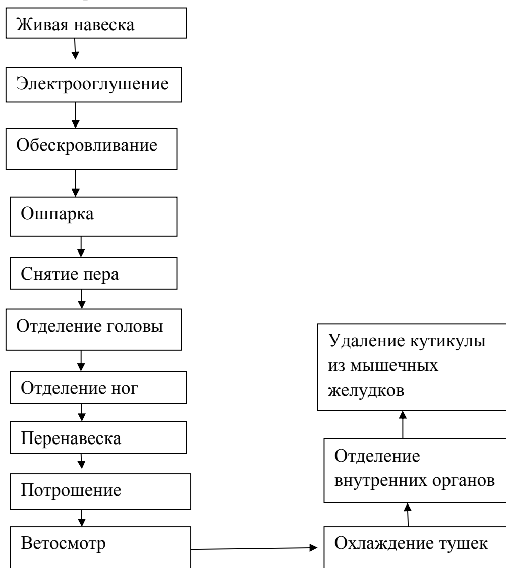
Рисунок 1 – Технология убоя птицы
