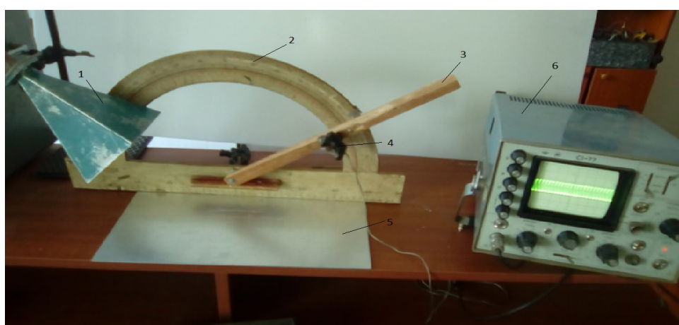
Рис.1. Установка для исследования отражения электромагнитных волн от металлической поверхности: 1 –излучающий рупор пирамидальной формы; 2 –система углового отсчета; 3 – подвижная штанга; 4 – детектор; 5 – металлическое зеркало; 6 – осциллограф С1-77.
