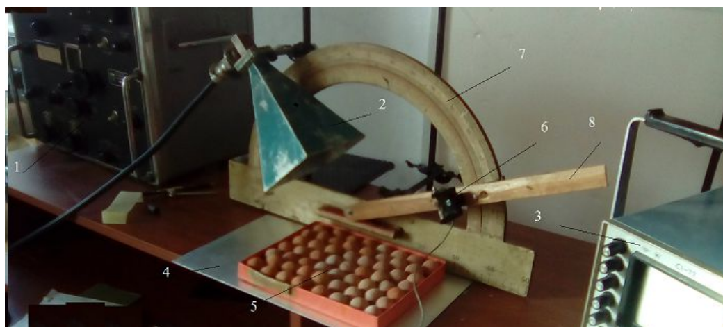
Рис.3. Установка с керамическими дискретными элементами. 1. Генератор ГЗ-14А. 2. Излучатель. 3. Осциллограф. 4. Металлическая поверхность.
