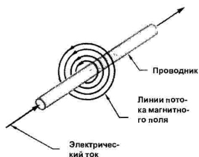
Рис. 1 Взаимодействие Проводников с током
