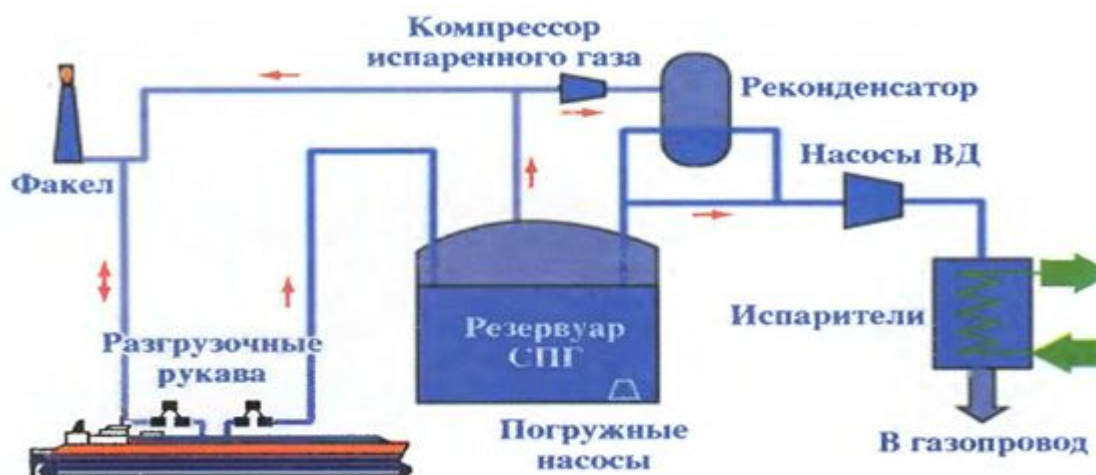
Рисунок 1- Принципиальная схема регазификационного терминала
