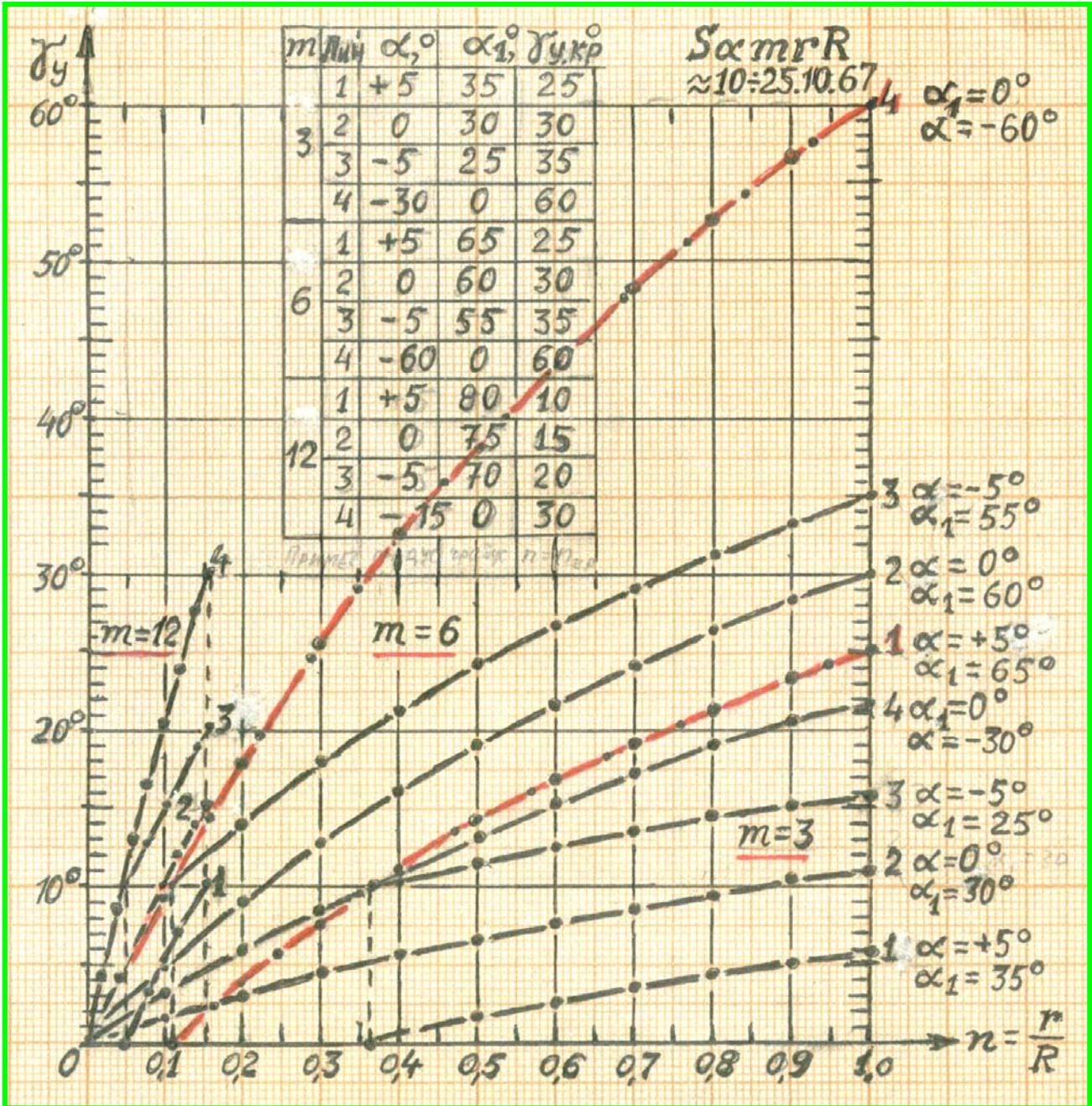
Зависимость угла коммутации. Управляемые схемы класса  $S\alpha m r R$
