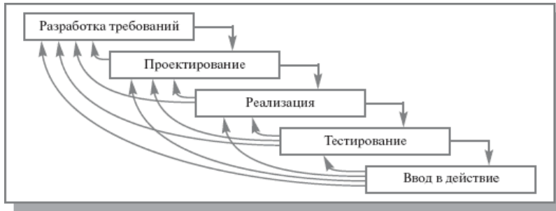
Рис.2 Поэтапная модель с промежуточным контролем
