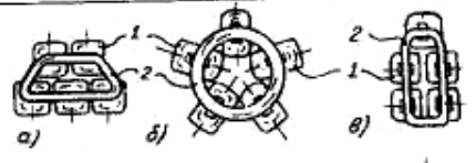
Рис.162. ВИП ВМ(А) на 3-стержневом (С=3) нелинейном магнитопроводе
