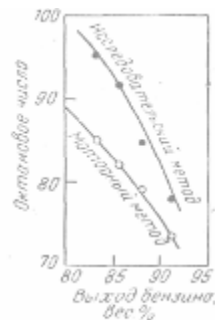
Рис. 63. Зависимость выхода бензина при каталитическом риформинге фракции 85–180 °С от его октанового числа.
