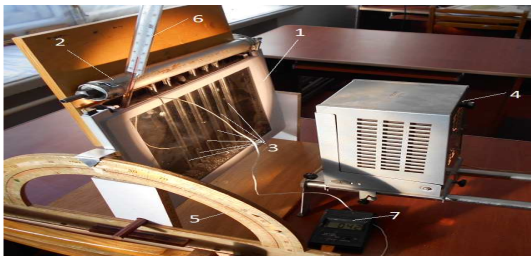
Рис.1. Модель солнечной термобатареи. 1. Корпус коллектора. 2.Теплообменник. 3.Термосифоны. 4. Фонарь создающий световой поток
