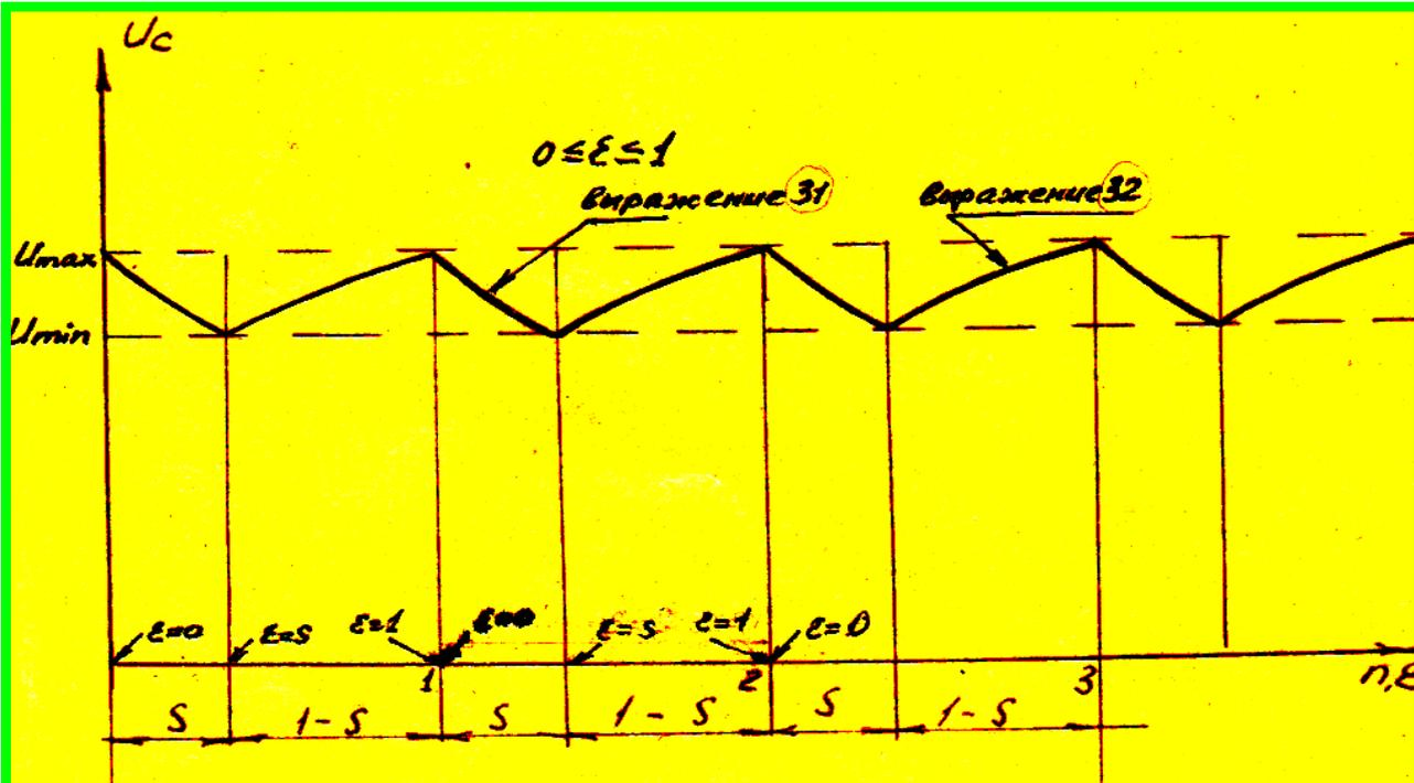
Фиг. 7. Форма установившегося напряжения на ёмкости
