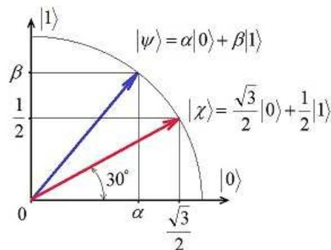
Исследуемый кубит на рисунке показан условно, для некоторых неопределённых заранее проекций  $\alpha$  и  $\beta$ . На самом деле вектор кубита может иметь любой угол по отношению к поляризатору. Напротив, используемый поляризатор имеет фиксированный угол наклона  $30^\circ$  к горизонтали. Действие, которое поляризатор окажет на исследуемые произвольные кубиты, согласно математике квантовых вычислений описывается проектором:
