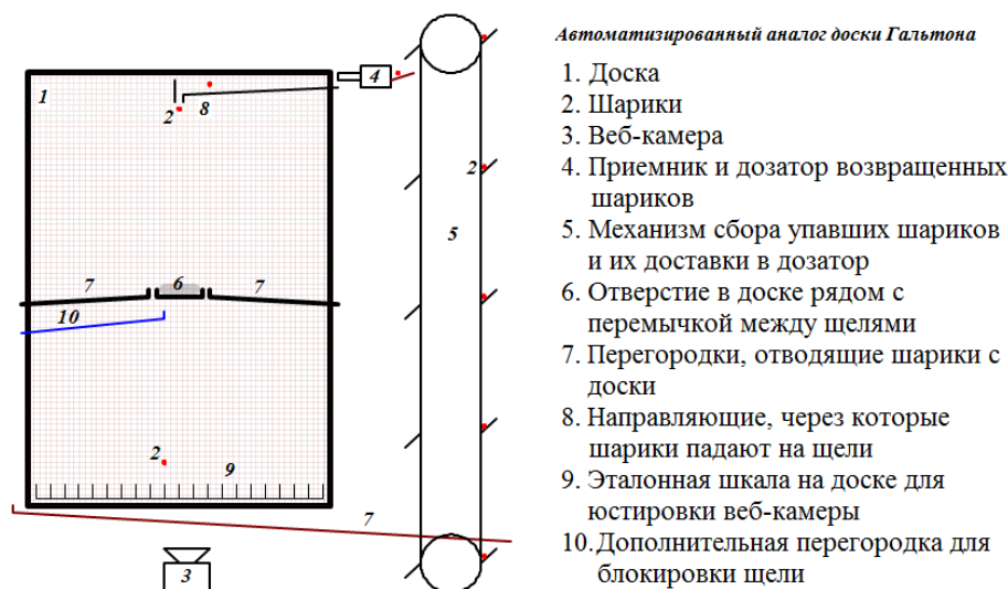
Рис.8. Интерференционная доска с автоматическим сбором информации
