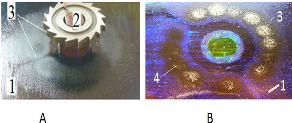
Рис. Коронарный отпечаток фрезы в жидком кристалле. 1. ЖК-детектор. 2. Фреза. 3 –отпечаток зуба фрезы . 4. ЖК-отпечаток зуба фрезы с дефектом.
