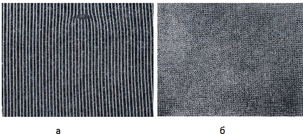
Рис.1.а. Домены Капустина – Вильямса НЖК с периодом w = 20\text{мкм} в МББА. U = 7,5\text{В} , f = 64\text{Гц} , T=25^{\circ}\text{С} . б. Неустойчивость в виде сетки с малым периодом U = 98\text{В} , d = 40\text{мкм} [1].
