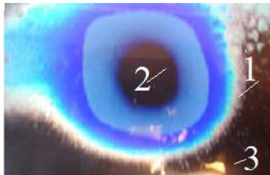
Рис.3. Срез электромагнитной волны на выходе из волновода. 1.Изотерма 40°C. 2.Область с температурой выше 45°C. Область с температурой ниже 40°C.
