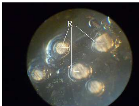
Рис.6. Форма отпечатка искрового разряда на фольге. Увеличение \times 124 .
