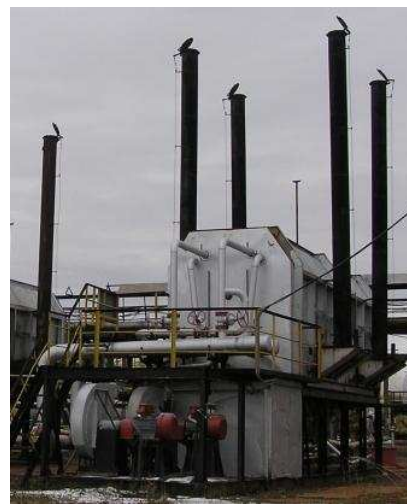
Рисунок 2 – Печь нагрева пламенная типа ПТБ-10
