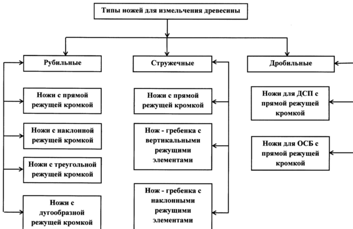
Рисунок 1- Классификация ножей для измельчения древесины
