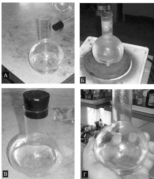
Рис.1. Этапы проведения эксперимента с колбой. А- заполнение колбы водой. Б-нагревание колбы. В- уплотнение открытого конца колбы, охлаждение. Г- запуск термосифона от тепла руки.
