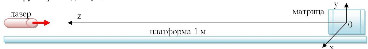
Рис.1. Схема галактического панорамного спидометра. Лазер и матрица жестко закреплены на платформе, которая закрыта кожухом для защиты от влияния внешней среды.
