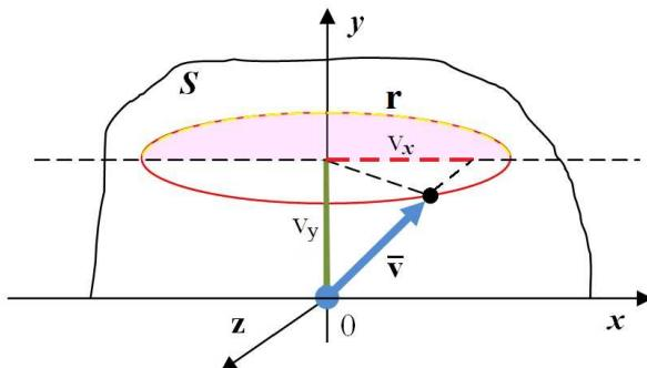
Рис.3. В процессе вращения платформы вокруг вертикальной оси конец вектора скорости  $\mathbf{v}$  в системе отсчета платформы описывает окружность  $r$ . Проекция вектора скорости на ось вращения  $v_y$  имеет неизменное значение. Величина проекции вектора скорости  $v_x$  на ось  $x$  зависит от направления этой оси в пространстве.
