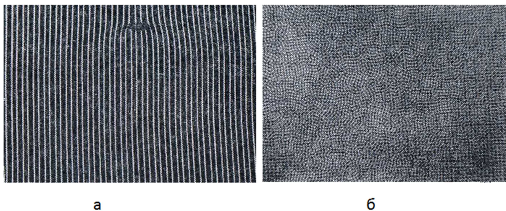
Рис.1.а. Домены Капустина – Вильямса НЖК с периодом w = 20\text{мкм} в МББА. U = 7,5\text{В} , f = 64\text{Гц} , T=25^{\circ}\text{С} . б. Неустойчивость в виде сетки с малым периодом U = 98\text{В} , d = 40\text{мкм} [1].
