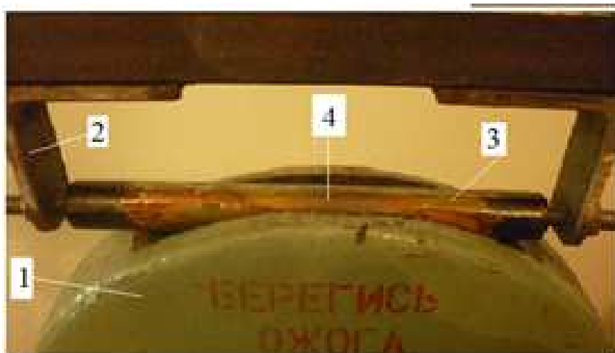
Рис. 1. Узел экспериментальной установки по исследованию сухого и мокрого трения по тепловым полям. 1. Корпус с подвижным чугуном диском. 2. Суппорт. 3. Стальная колодка. 4. Слой жидких кристаллов холестерического типа с мезофазой 40-45°с.
