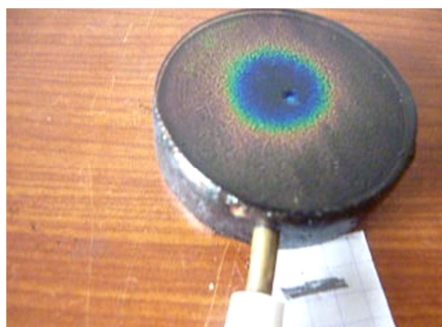
Рис.8. Визуализация поля воздействия коронарного разряда на алюминиевый образец. Коронирующий электрод положителен. Плоский электрод (образец) отрицателен.
