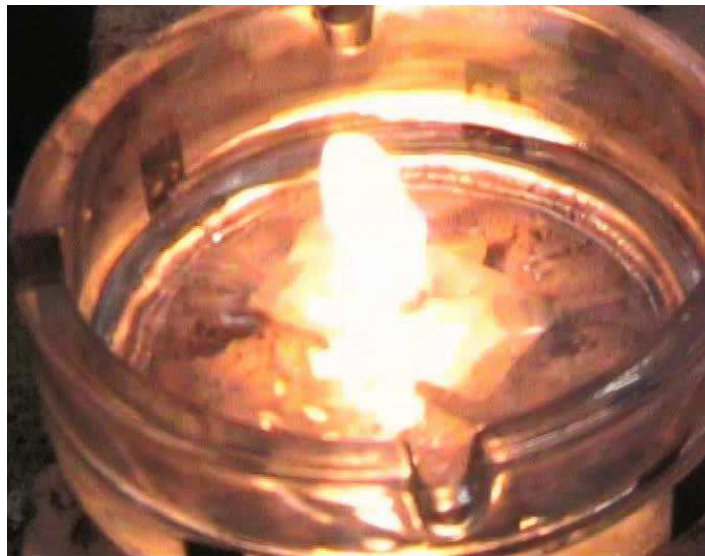
Рис.3. Кадр видеogramмы с воспламенением дизельного топлива частицей ( d=6 \cdot 10^{-3} м, h=3 \cdot 10^{-3} м, глубина слоя топлива s=3 \cdot 10^{-3} м, T=1393 К).
