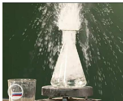
Рис.3. Перегретая жидкость. Вода в колбе была нагрета до температуры выше 100 градусов. Но она не закипела. После того, как лектор добавил в колбу щепотку мела, вода мгновенно взрывоподобно закипела. ([http://youtu.be/2dVJV\\_QC5pc](http://youtu.be/2dVJV_QC5pc))
