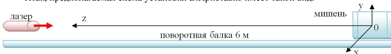
Рис.5 Схема экспериментальной установки В.Приставко. Лазер и мишень жестко закреплены на деревянной поворотной балке.
