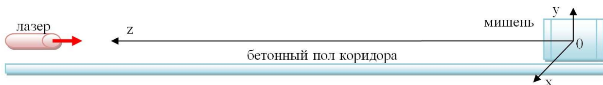
Рис.3 Схема экспериментальной установки А.И.Довженко с лазерной указкой. Указка и мишень (тетрадный лист) жестко закреплены на полу. Длина коридора - ок.60 метров.
