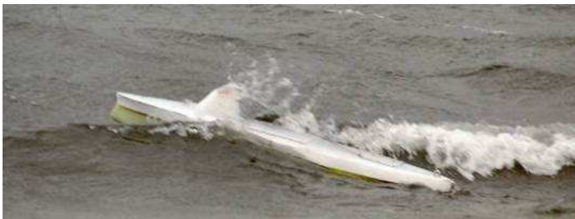
Рис. 7. Испытание ходкости и оценка мореходных качеств телеуправляемого гидрофизического модуля на обрушающейся штормовой волне при ветре порядка 10-12 м/с.
