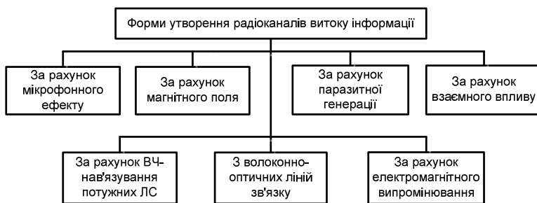
Рис.4. Форми утворення радіоканалів витоку інформації
