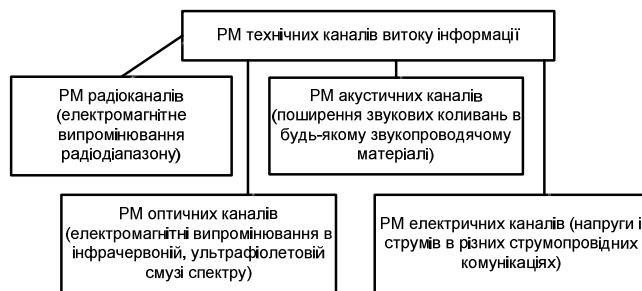
Рис.2. Види РМ технічних каналів витоку інформації
