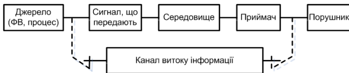
Рис. 1. Структура каналу витоку інформації
