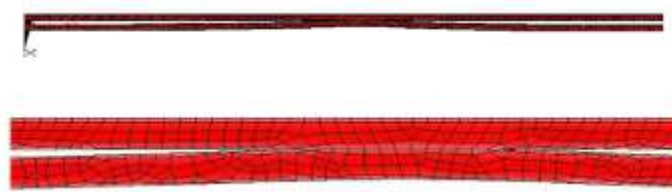
Рис.3. Сетка КЭ системы, состоящей из двух контактирующих нанотрубок.
