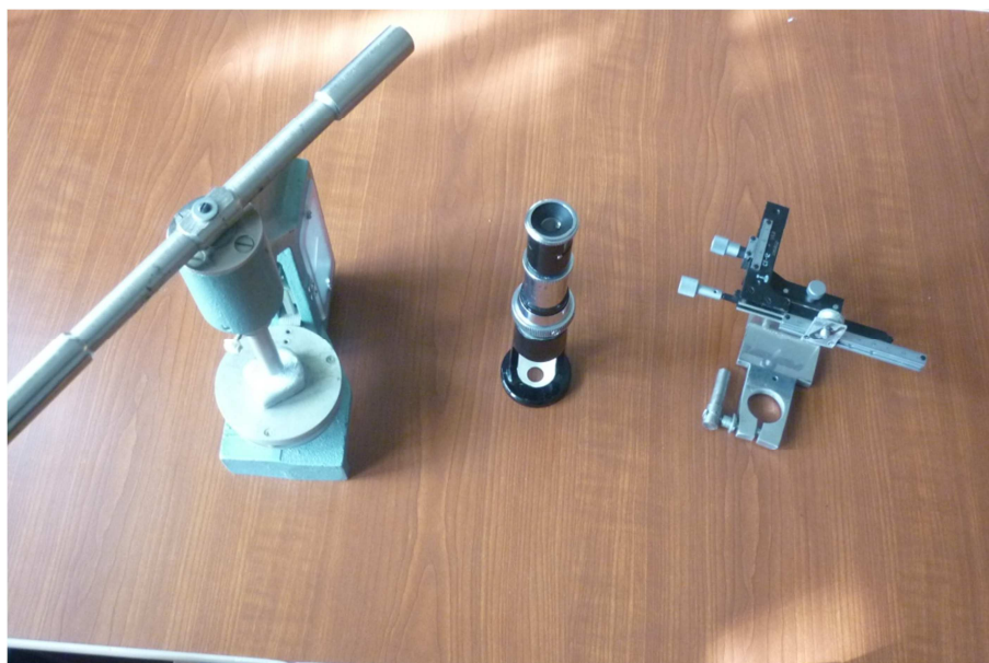
Рис.1. Слева на право. 1.Ручной твердомер на 2000 Н с образцом, 2.Измерительный микроскоп, 3.Двухкоординатный адаптер для фотокамеры.
