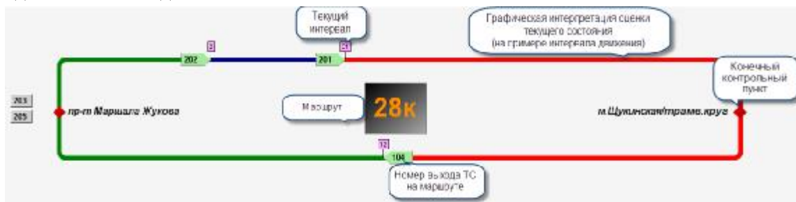
Рисунок 5. Программная реализация мнемосхемы движения ТС на маршруте
