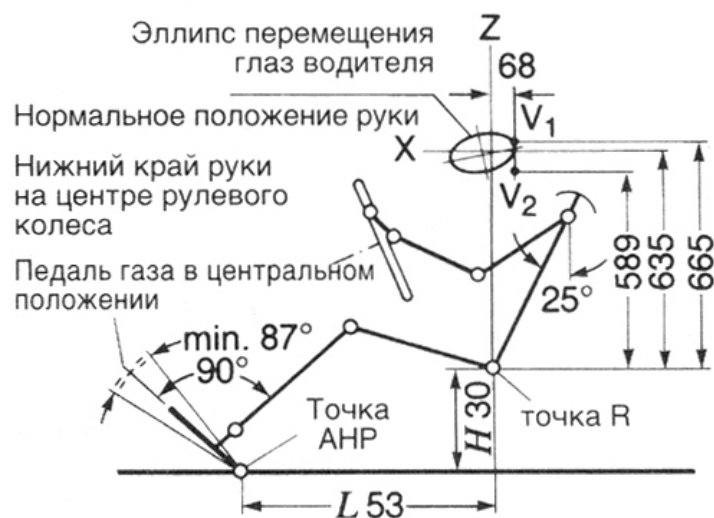
Рисунок 5 – Параметры, определяющие место расположения сидения водителя в легковом автомобиле
