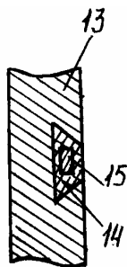
Рис.VIII-5 Местный вырез по креплению
