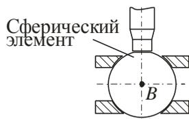
Рис. 3. Центр идеального сферического шарнира
