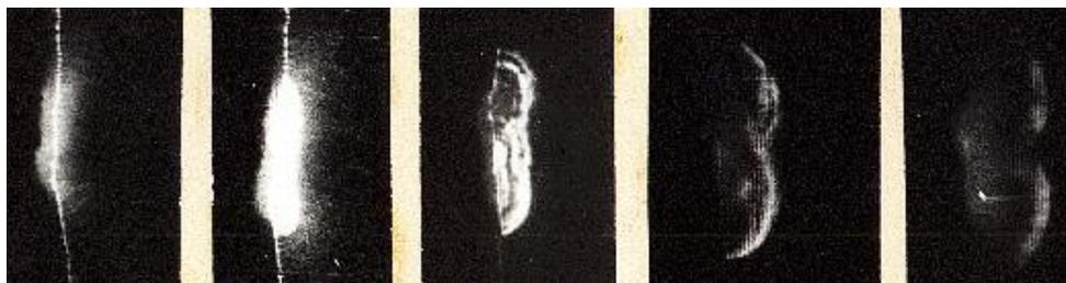
Рис.4. Динамика расширения плазменного микрошнура. Излучающий разряд в воздухе, разрядный промежуток - 0,5 мм, аперийодический импульс тока с амплитудой 750 А имел длительность 400 нс. Экспозиция - 10 нс, интервал между кадрами - 100 нс.[12].
