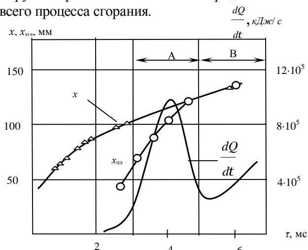
Рис. 1. Связь распространения горения по топливной струе с характеристикой скорости выделения тепла при P_{\Gamma} = 5,0 МПа; T_{\Gamma} = 736 К, d_c = 0,29 мм; b_{ц} = 0,12 г/цикл; A – кинетическое (быстрое) горение; B – диффузионное горение; x и x_{пл} – проникновение вершины топливной струи и распространение пламени по струе; dQ/dt – скорость выделения тепла [1].
