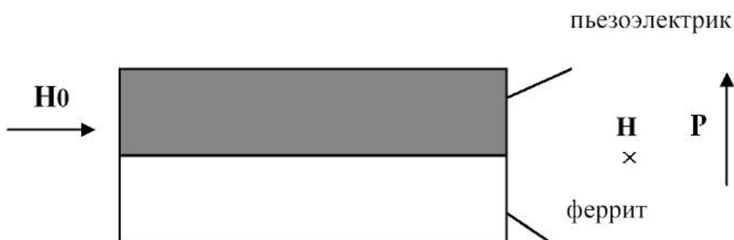
Рис. 1 Двухслойная феррит-пьезоэлектрическая структура. \mathbf{P} – вектор поляризации пьезоэлектрика, \mathbf{H}_0 – подмагничивающее поле. Переменное поле \mathbf{H} направлено перпендикулярно плоскости рисунка
